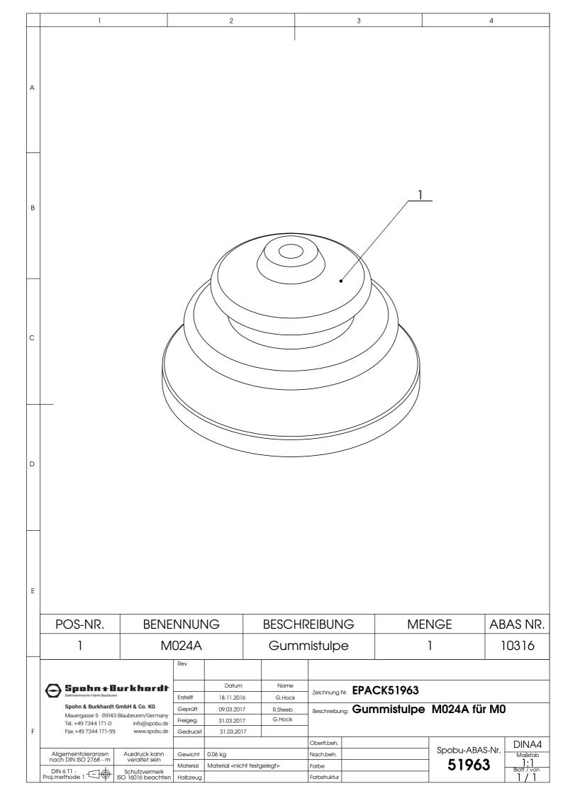
Gummistulpe Ø 48 mm für M0 Rubber boot Ø 48 mm for M0
